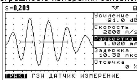
Рис. 9. Экран дефектоскопа при измерении периода основной частоты радиоимпульса.
