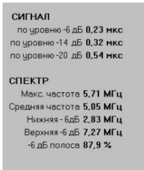
Временная и спектральная характеристика эхо-импульса преобразователя П111-6,0-С-001 полученные с помощью программы UdProbe. Донный эхо-импульс, образец СО-3.
